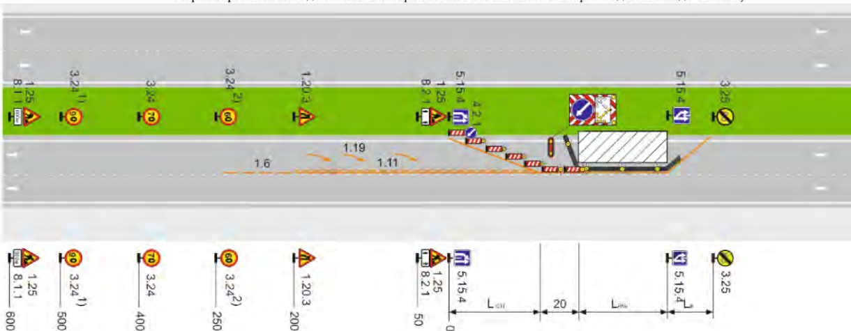
Рисунок Б.20 – Автомагистраль, скоростная дорога, шестиполосная дорога обычного типа. Рабочая зона производства долговременных работ на крайней правой полосе. Пропуск транспортных средств по двум полосам с предварительным изменением траектории движения
